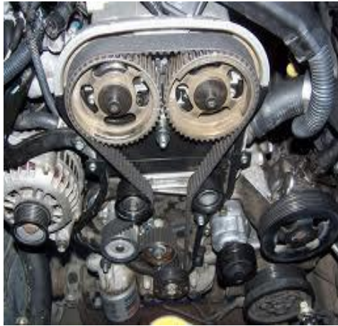
แสดงเครื่องยนต์ที่ส่งกำลังขับเคลื่อนเพลาลูกเบี้ยวโดยสายพานไทม์มิ่ง
