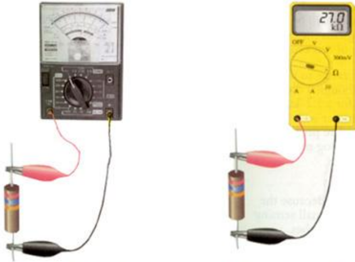
การวัดค่าความต้านทานด้วยมิเตอร์แบบเข็ม
