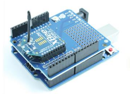
รูปที่2 บอร์ด Arduino ต่อกับบอร์ด XBee Shield
