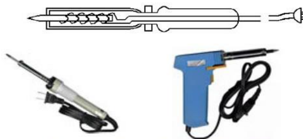
รูปที่ 12.2 แสดง ลักษณะและโครงสร้างภายในของหัวแร้งแช่
