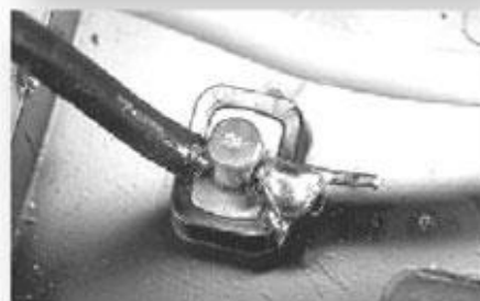
จุ่มตะกั่วมากเกินไป และตะกั่วไม่จับชิ้นงาน
