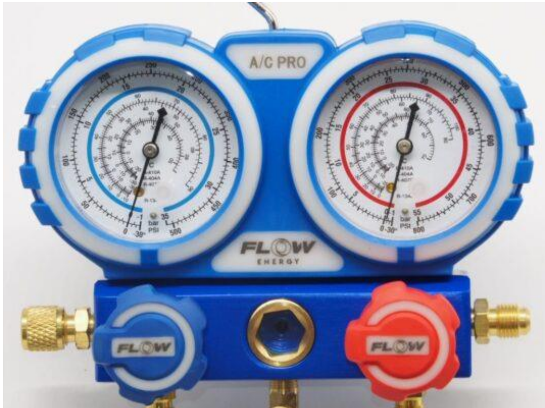
เกจวัดแรงดันน้ำยาเครื่องปรับอากาศ
